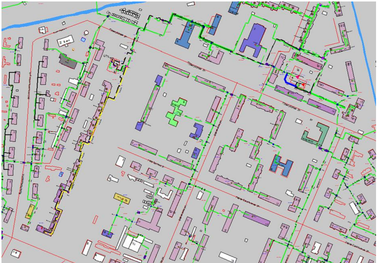
Рисунок 3.67 – Трассировка теплопровода от котельной АО «Теплоэнерго» по ул. Премудрова, д. 12А до конечного потребителя «ПТ-Днепр,16 э4»
