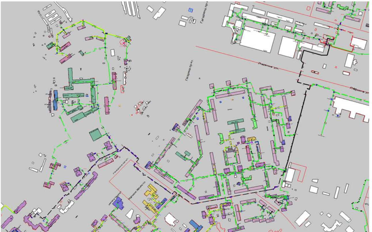
Рисунок 3.43 – Трассировка теплопровода от котельной АО «Теплоэнерго» «Термаль» по пр. Гагарина, д. 178Б до конечного потребителя «ПТ-Гагар.пр,101 корп.5 ИТП №2»
